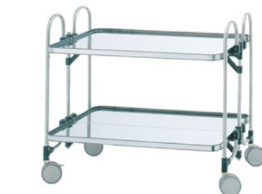
⑨ アボジワゴン2段 (折りたたみ式) KEA-2 613×505×H838mm 重量12kg ¥90,000 KEAM-2 763×505×H838mm 重量15kg ¥110,000 KEAW-2 933×505×H838mm 重量17kg ¥120,000 ●キャスター: ナイロンエラストマー双輪 φ100mm×4自在 (2輪ストッパー付) ●耐荷重: 30kg (1段あたり) ●材質: SUS430ステンレス
