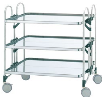
⑩ アボジワゴン3段 (折りたたみ式) KEA-3 613×505×H958mm 重量17kg ¥120,000 KEAM-3 763×505×H958mm 重量21kg ¥134,000 KEAW-3 933×505×H958mm 重量25kg ¥150,000 ●キャスター: ナイロンエラストマー双輪 φ100mm×4自在 (2輪ストッパー付) ●耐荷重: 30kg (1段あたり) ●材質: SUS430ステンレス
