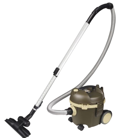
⑧業務用小型ドライバキューム極HOTEL MC-H100 310×320×H320mm ¥37,850 質量:4.3kg (本体のみ) 電源:単相100V 50/60Hz 消費電力:最大/1,200W、最少/1,000W 運転音:最大/65dB、最少/55dB 集塵容量:紙バッグ5ℓ 強・弱無段階パワーセレクト:真空圧最大/1,950mmAq、最小/1,750mmAq アンペア:最大/12A、最小/10A 電源コード:長さ約8m 付属品:フロアノズルN、ホースアッセンブリー、紙バッグ用リング、伸縮延長管、スキマノズル、丸ブラシ、紙バッグ×3、断線防止フック、断線防止ゴム紐、断線防止ショートケーブル ●コンパクト・軽量設計で複雑な室内空間のお掃除もラクラク。 ●通常～強で強力バキューム。隣室へ配慮が必要な場合は弱にて静音にできます。
